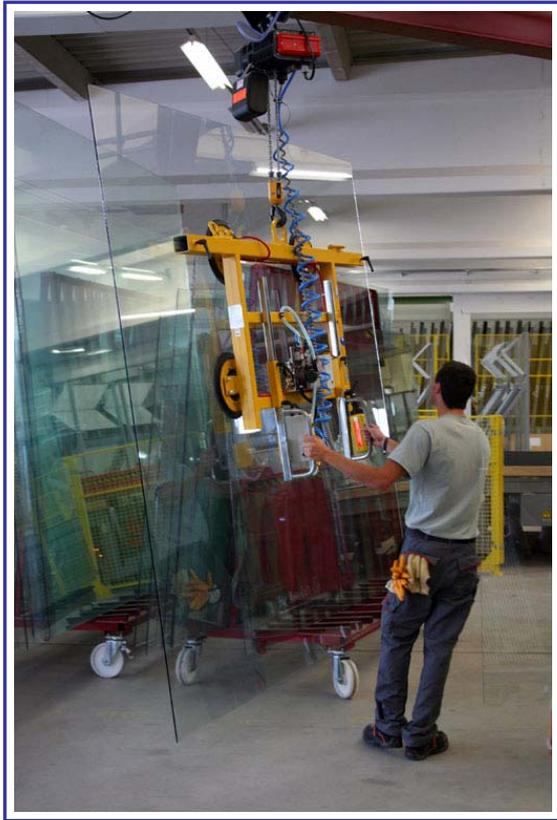
En los puntos de sellado manuales integrados para cristales de vidrio aislante especiales, se utiliza el aparato de manipulación 7025-MS4/E para colocar los cristales desde la mesa de sellado hasta los soportes. Con este aparato pueden bascularse pesos de hasta 500 Kg. Este aparato de manipulación también puede equiparse con prolongaciones adicionales.
