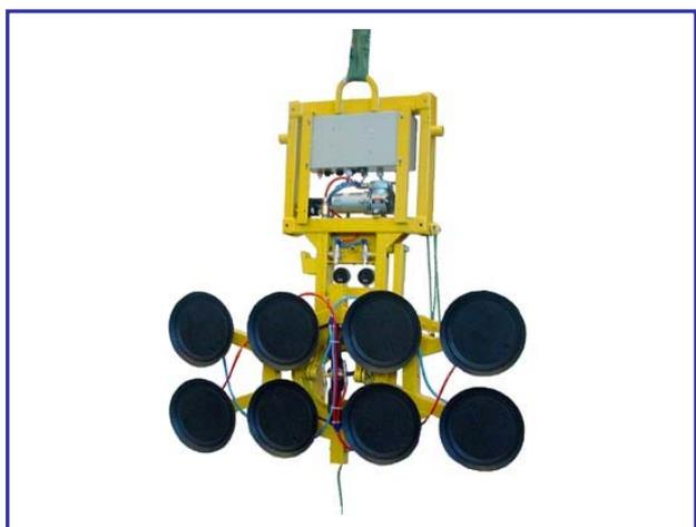
Le point de suspension de l'appareil a été disposé tellement près du centre de gravité de l'appareil chargé que l'angle d'inclinaison de l'appareil, même avec 1000 kg, est très faible, c'est-à-dire presque à la verticale. C'est un point capital pour les opérations entre échafaudage et façade de bâtiment.
