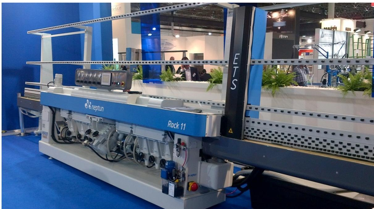
Dopo il grande successo commerciale della prima molatrice CN Rock con il sistema di squadratura ETS che, grazie alla lettura delle geometrie e dimensioni in ingresso tramite un sistema laser ed alla gestione di tre assi controllati da un potente CN, permette di molare la lastra alle dimensioni desiderate portandola in squadra a 90°, ora Neptun ha implementato anche la possibilità di gestire il fuori squadra della stessa.
