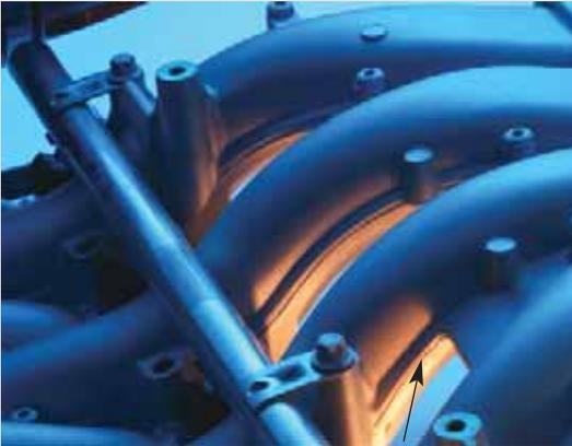
*Magnesiumverklebung an Saugrohrmodulen von Motoren mit DELO-MONOPOX*
