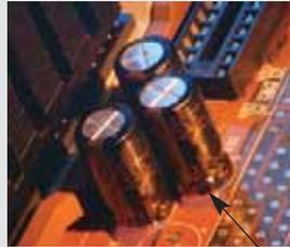
*Vibrationsschutz von gelöteten elektronischen Bauteilen*
