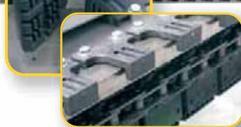
**Sistema meccanico** per la regolazione dell'apertura del carro.
